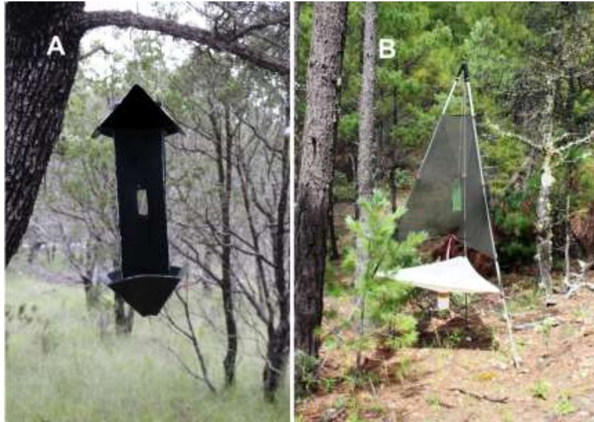
Figura 8. Ejemplos de otros tipos de trampas diseñadas para atraer a los insectos descortezadores en combinación con compuestos semioquímicos: A) trampa de panel, B) trampa Trinet.
